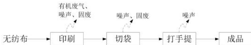
图 2-1 项目无纺布袋生产工艺流程图
