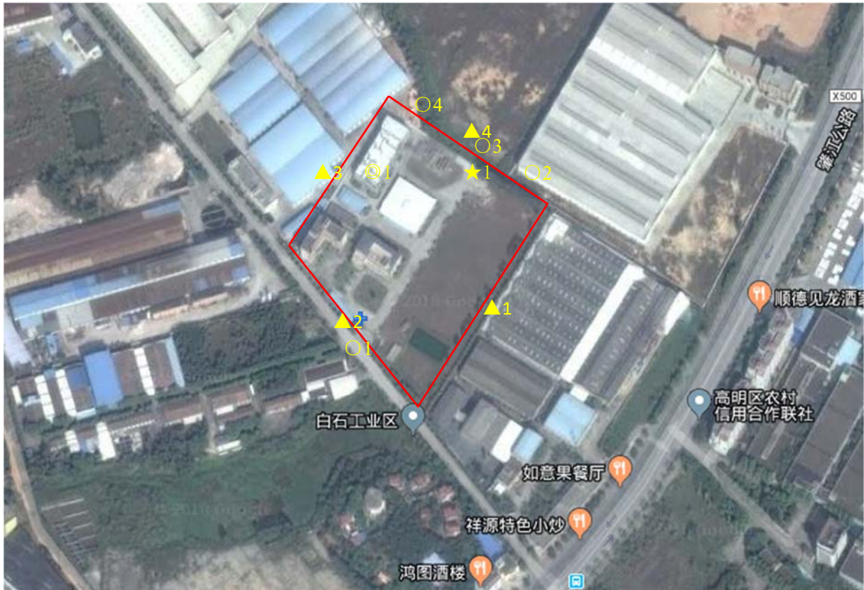
图 9-1 监测点位图（▲表示噪声、★表示废水、◎表示有组织废气、○表示无组织废气）
